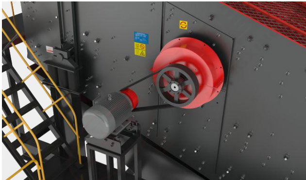
Быстро отрегулируйте частоту вибрации, заменив шкив Quickly adjust the vibration frequency by replacing the pulley
