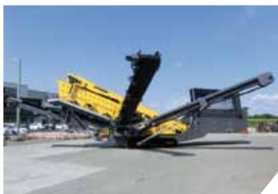
Загрузочный бункер оснащен колосниковой решеткой, имеющей возможность регулировки с помощью пульта дистанционного управления.
