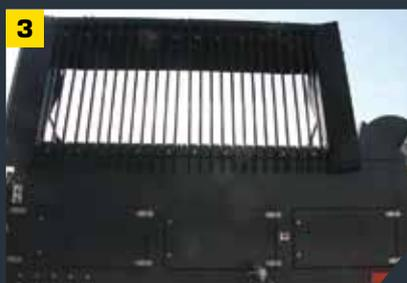
**3** Бункер 10 м<sup>3</sup>, длиной 5.400 мм и проёмом решетки 4.640 мм
