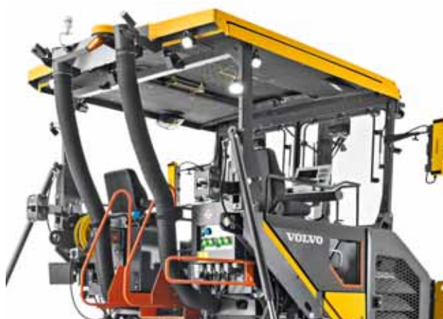
Переднее лобовое стекло и защита от атмосферных воздействий
