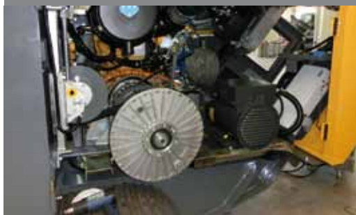
Незначительный расход топлива благодаря эффективной дизель-электрической концепции привода (ок. 19 л/ч)
