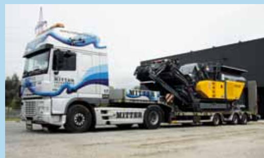
Незначительные размеры и вес дробильной установки RM80 GO! позволяют транспортировку без специальных разрешений
