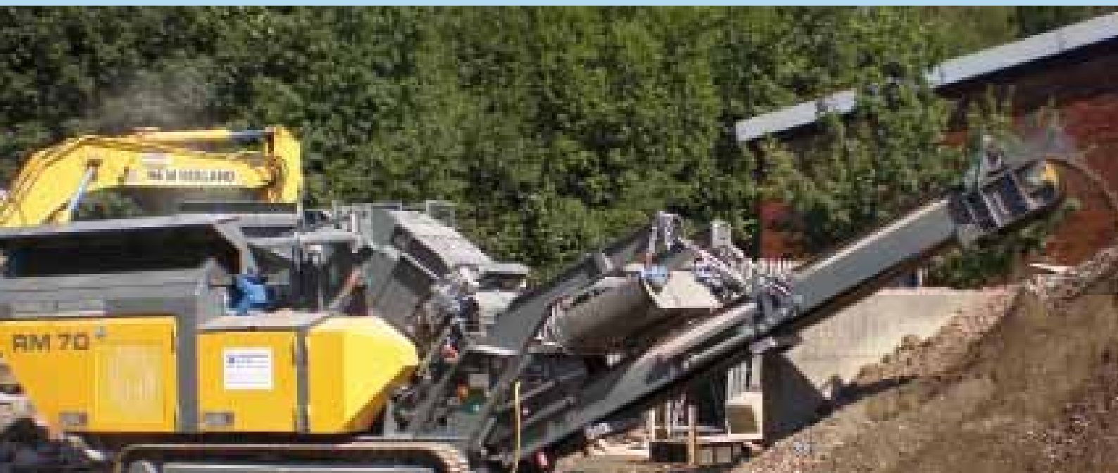
RM80 GO! в работе на дроблении строительного лома в Австрии
