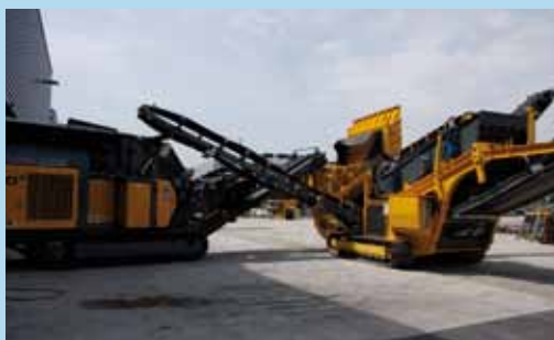
Возможность совместного использования дробильной установки RM80 GO! с виброгрохотом TS3600 для получения качественного конечного продукта
