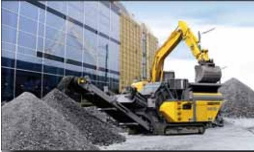
Специальный звукопоглощающий кожух системы шумоизоляции «enviro» обеспечивает значительное снижение уровня шума
