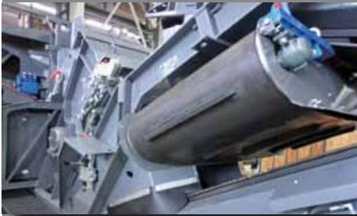
Эффективное удаление металлических включений при помощи магнитного сепаратора, установленного поперечно направлению основного разгрузочного конвейера
