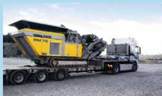
Незначительные размеры и вес дробильной установки RM70 GO! позволяют осуществлять транспортировку без специальных разрешений
