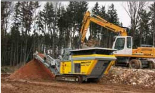
Дробильная установка RM70 GO! на дроблении строительного лома
