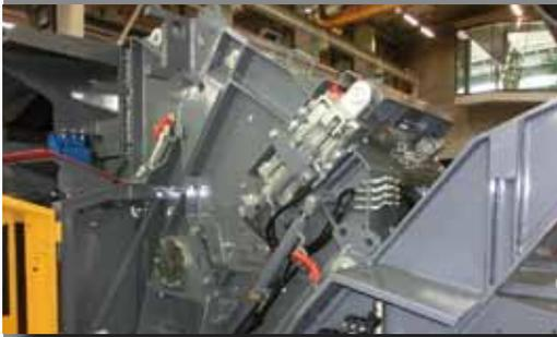
Возможность получения различных конечных фракций за счёт применения гидравлической системы регулировки зазора дробления
