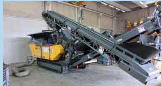
RM70 GO! оснащённая отделителем негабарита OS70 вместе с конвейером возврата негабарита RFB70
