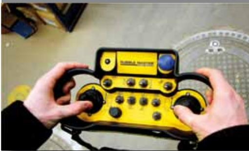
Пульт дистанционного радиуправления позволяет управлять основными функциями дробильной установки на расстоянии
