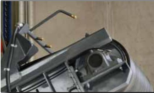
Эффективная система подавления пыли позволяет снизить пылевую нагрузку на дробильную установку и окружающую среду более чем на 75%
