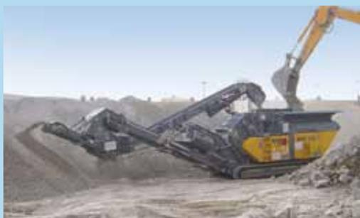
Дробильная установка RM70 GO! с OS70 на дроблении строительного лома
