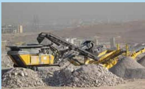
Возможность совместного использования дробильной установки RM70 GO! с виброгрохотом CS3600 для получения качественного конечного продукта
