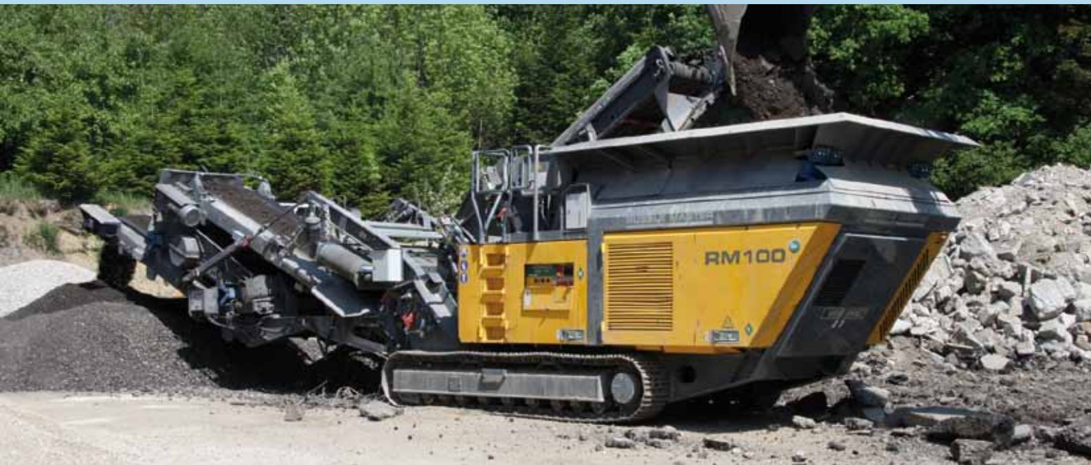
RM100 GO! в работе на дроблении строительных отходов в России
