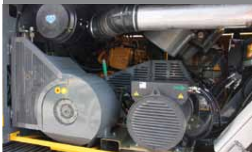
Незначительный расход топлива благодаря эффективной дизель-электрической концепции привода (ок. 22 л/ч)
