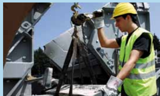
Минимальное время простоя оборудования благодаря специальному устройству для замены бил (опция)
