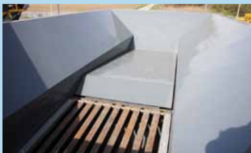
Конструкция загрузочного бункера обеспечивает оптимальную подачу загружаемого материала в дробильную камеру
