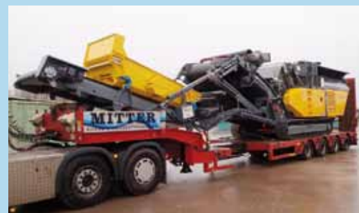
Перевозка дробильной установки RM100 GO! с грохотом MS100 GO! на одном низкорамном прицепе
