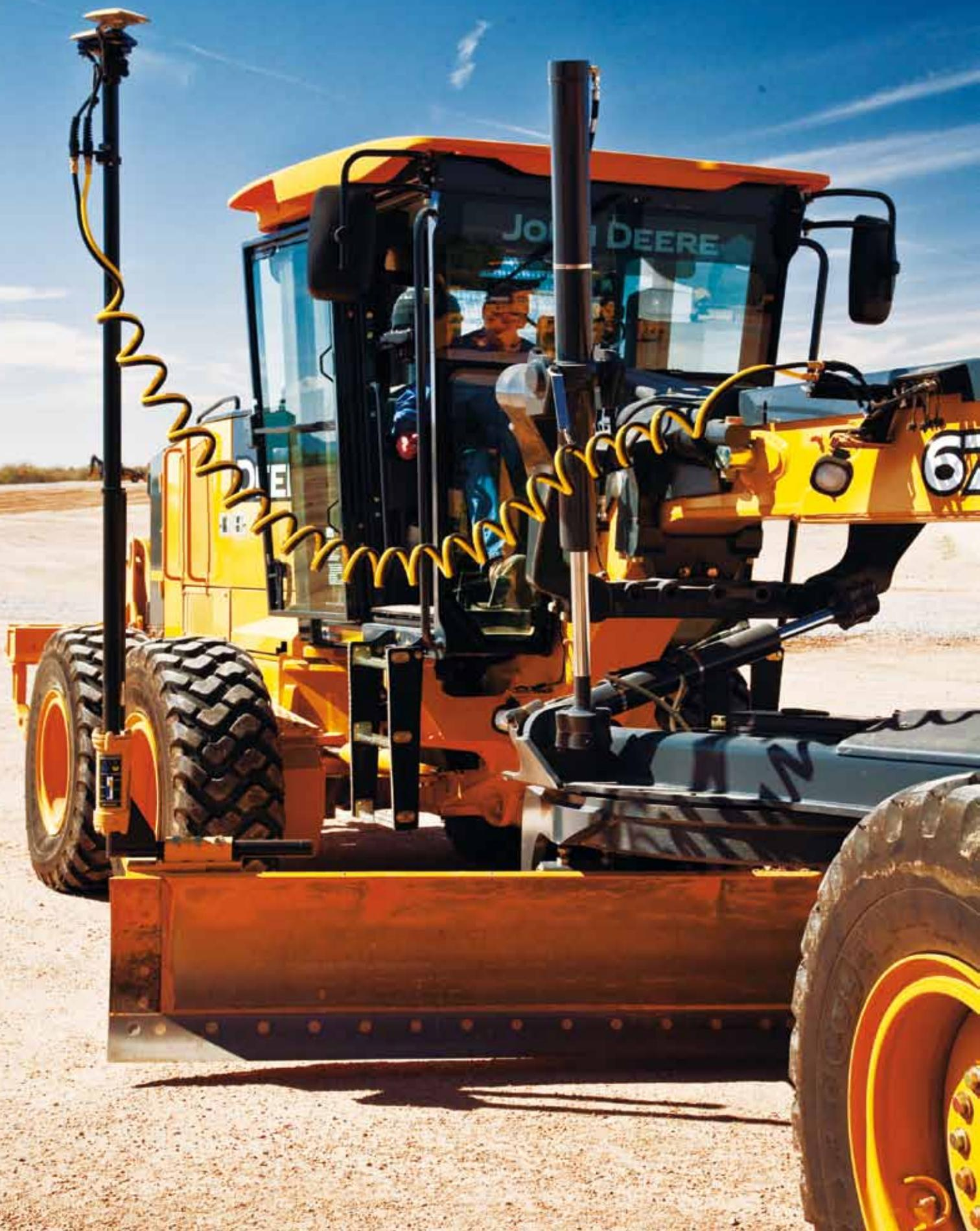
**3D** система контроля и нивелирования Торсон 3D ГНСС является великолепным решением для автоматизации процесса выравнивания грейдерами John Deere. Система Торсон имеет понятный операторский интерфейс, простую настройку оборудования и возможность легкой модернизации. Эта система отлично подходит для решения многообразия сложных задач.
