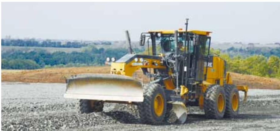
*ГНСС – со спутниковым приемником ГЛОНАСС/GPS*
