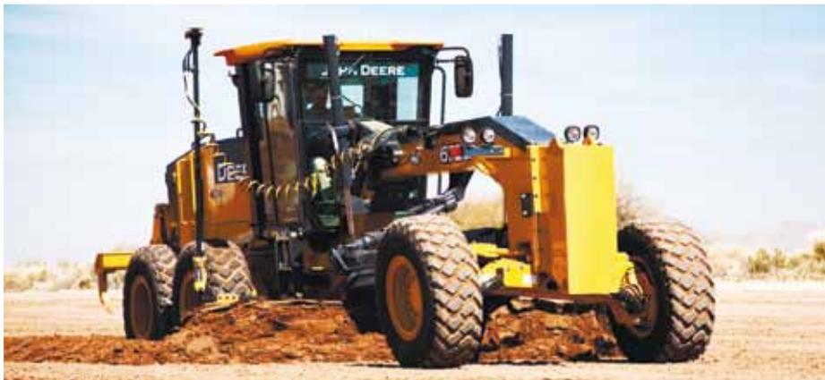
*mmGPS – спутниковая ГНСС система с PZS-МС датчиком*
