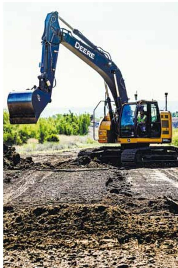
**3D** Система Торсон 3D включает две ГНСС антенны для позиционирования и ориентации машины на участке, четыре датчика наклона с диапазоном определений 360° для измерения углов между кабиной, стрелой, рукоятью и ковшом, спутниковый ГНСС приемник и панель управления GX с цветным сенсорным экраном.
